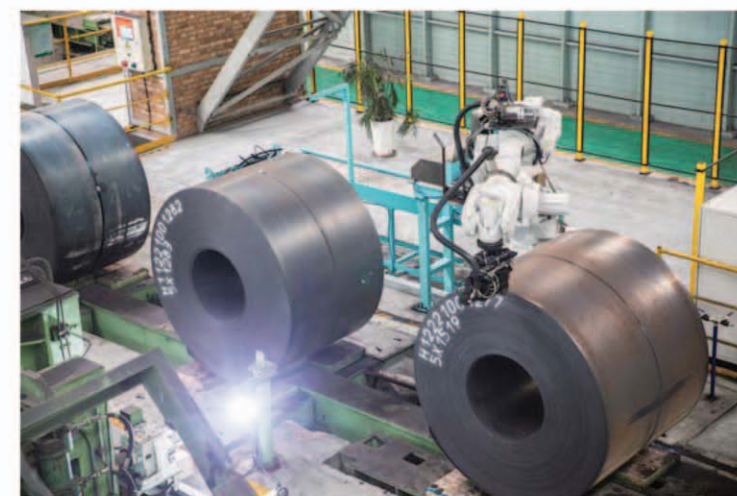
山钢集团日照公司热轧厂精整作业区，新“上岗”的拆捆机器人正在作业
